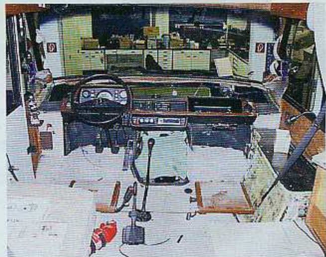
■ Der Fußboden wird mit Schwerschicht gedämmt und dann mit Teppichboden verklebt.
