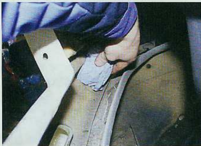
■ Die Spritzwand zum Innenraum wird ebenfalls mit Schwerschicht gedämmt, nachdem der Untergrund ordentlich entfettet wurde.
