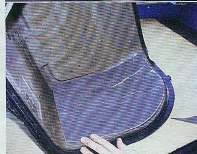
■ Auch die hässlich beklebte Motorabdeckung wird demontiert, vom Teppich befreit und innen mit Schwerschicht gedämmt.
