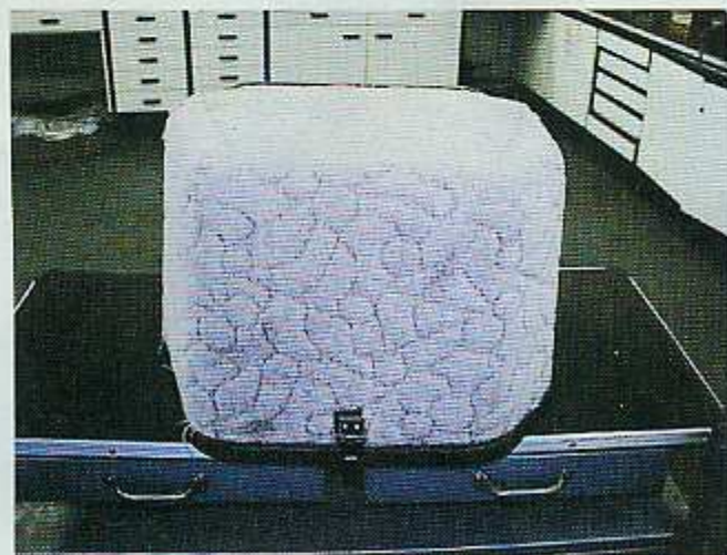
■ Die Schwermatte lässt sich genial einfach verarbeiten: Ausmessen, zuschneiden, entfetten und passgenau an die Form gebracht aufkleben, fertig.
