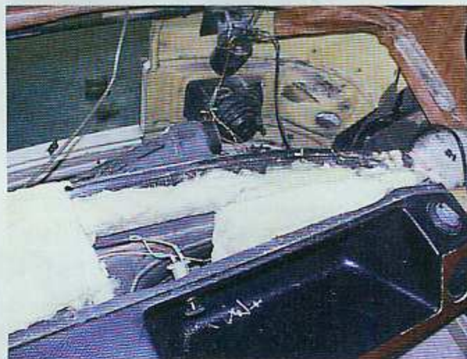
■ Ablage und Armaturentafel waren richtige Resonanzkörper. Jetzt werden sie wirksam gedämmt.
