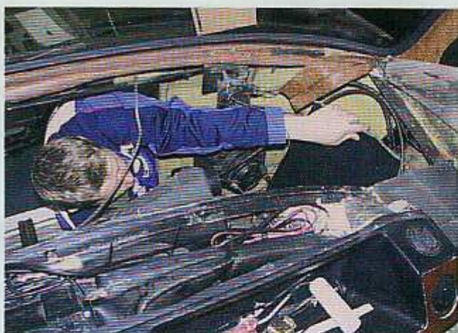
■ Der Motorraum wurde mit einer Schwerschicht gedämmt.
