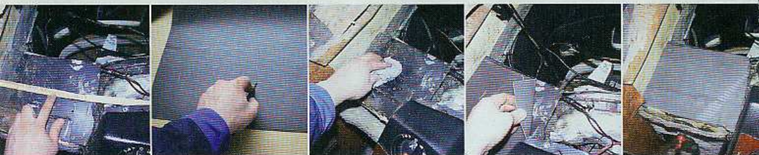
■ Die Schwermatte lässt sich genial einfach verarbeiten: Ausmessen, zuschneiden, entfetten und passgenau an die Form gebracht aufkleben, fertig.
