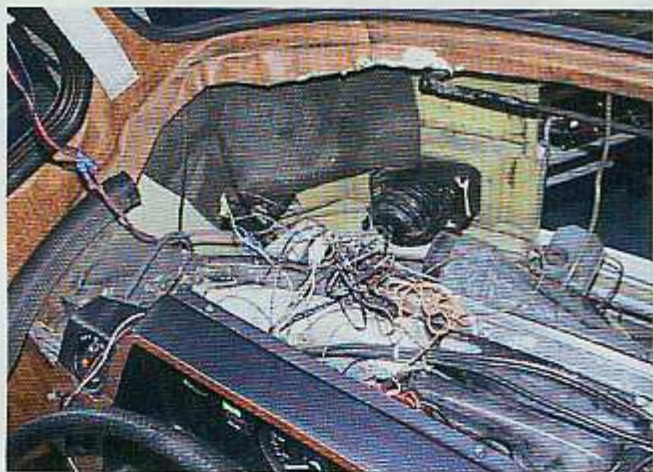
■ Die GfK-Teile der Frontmaske erhielten eine Dämm- und Antidröhnbeschichtung
